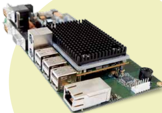
Skräddarsytt bärarkort till en COM modul – utvecklat av Prevas.
